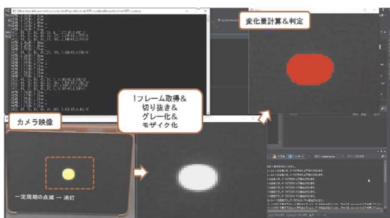
Fig. 3 映像の誤動作検知システム動作画面
