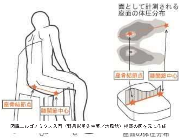
Fig. 2 面として計測される座面全体の体圧分布と、矢状面から見た座骨結節点前後の体圧分布
